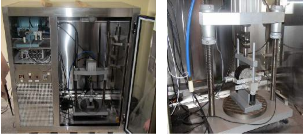
Şekil 6. İndirekt Çekme Aletine Numunelerin Yerleştirilmesi
